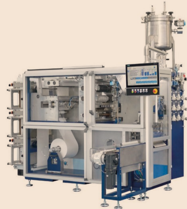
Macchina per il confezionamento monodose Alpha, la più venduta con una produzione fino a 300 pezzi al minuto
